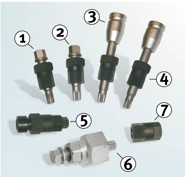
Kuva 5: Erilaisien yhdensuuntaisten hihnapyörien irrotukseen ja asennukseen tarvittavat erikoistyökalut
